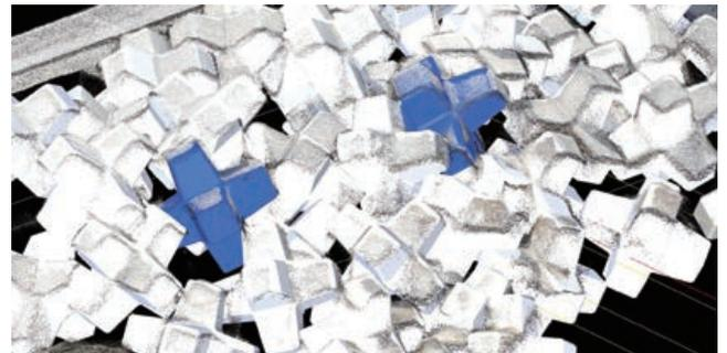
図1 点群と消波ブロックモデル
