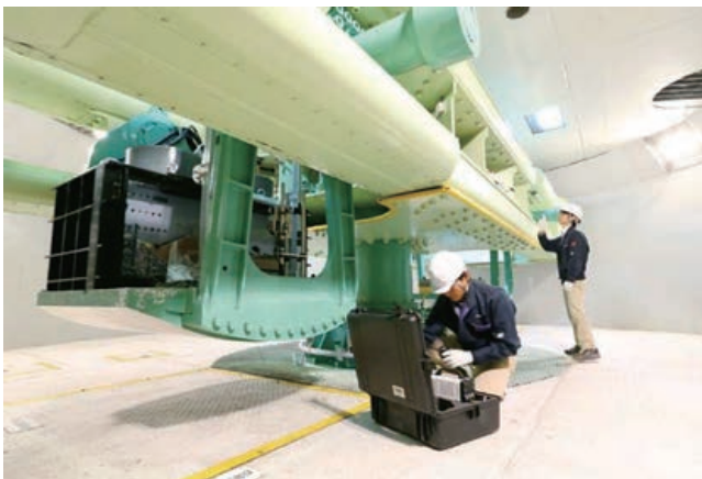
模型に遠心力を加え実物スケールでの動きを再現できる遠心模型実験装置
