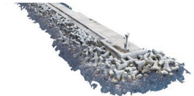
無人航空機(UAV)による防波堤の測量結果を3次元データ化したもの
