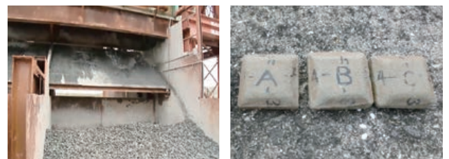
図3 脱水固化石材製造と脱水固化石材(70mm×70mm×35mmの例)
