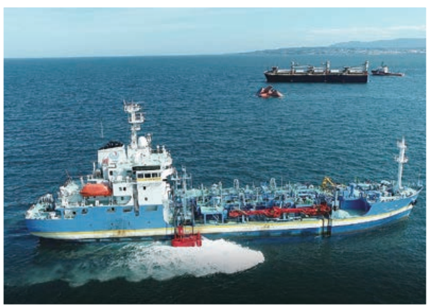
八戸港沖での油回収作業中の大型浚渫兼油回収船「白山」 （総トン数4,185トン、全長93.9m×幅17m×喫水5.4m）
