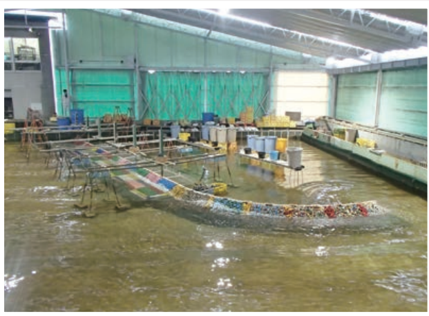
名古屋港新土砂処分場護岸の平面水槽実験の様子
