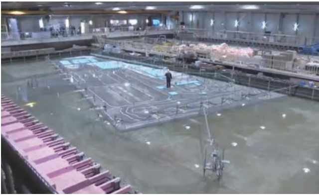
大型水槽における岸壁上の浸水実験
