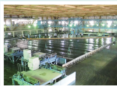
潮流・波浪実験水槽による実験の様子
