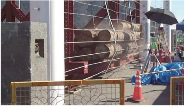
写真1 須崎港 津波バリアの衝突実験
