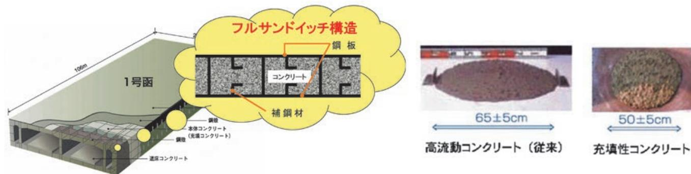
図1 北九州港 沈埋函の構造（提供：九州地方整備局北九州港湾・空港整備事務所）
