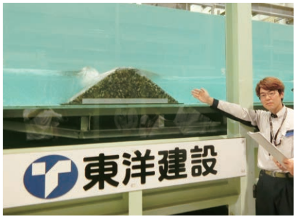
二次元造波水路での耐波実験
