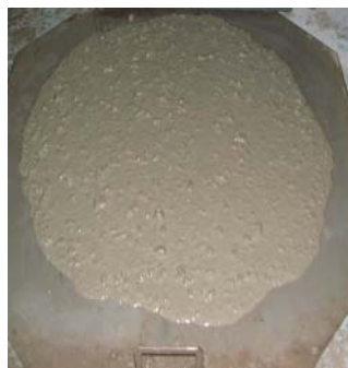
写真-2 スランブフロー試験 (ケースUL)
