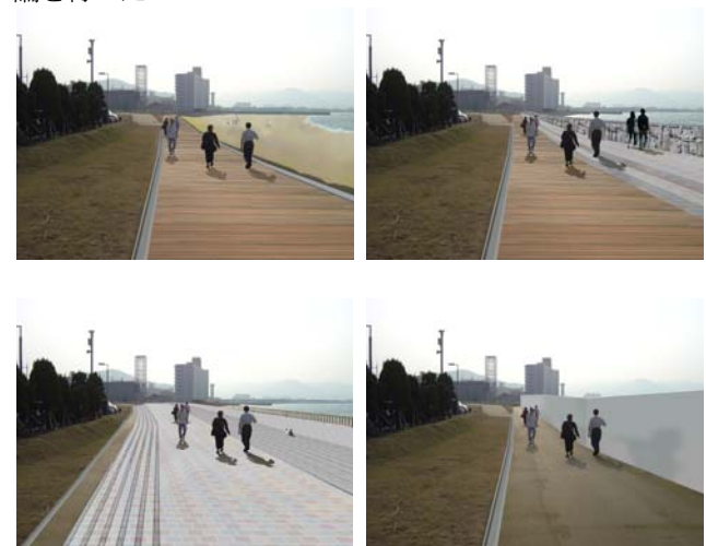
図-5 シーフロントプロムナードの代表的な整備メニュー（CG）（左上：人工海浜案、右上：波返し形状改良案、左下：緩傾斜護岸案、右下：護岸嵩上げ案）
