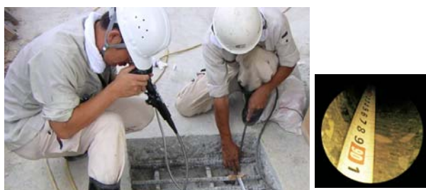
写真-2 ファイバースコープによる観察状況
