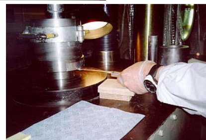
写真-3 細孔溶液抽出装置、抽出状況
