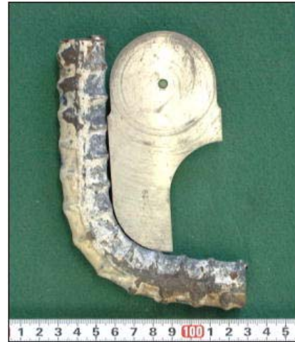
写真-4 鉄筋曲げ半径計測
