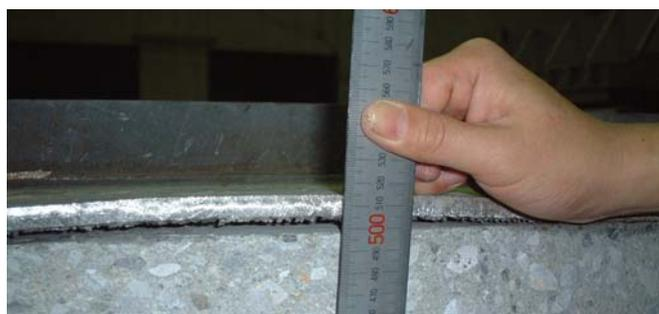
写真-4 鋼コンクリート間の剥離
