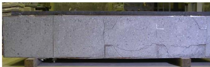
写真-3 ひび割れ発生状況 (試験体2)
