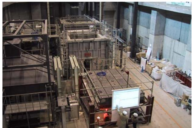
写真-2 耐火試験状況
