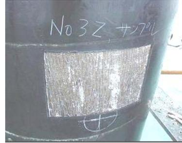
写真-2 ポリエチレンライニング下の鋼材表面
