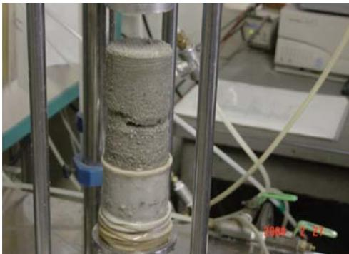
図-2 固結した水砕スラグのネッキング破壊
