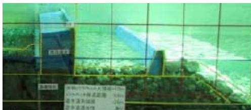
写真-3 二重護岸(透水性あり)の模型 2)
