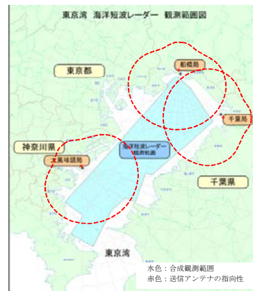
図-3 東京湾の海洋短波レーダの設置状況
