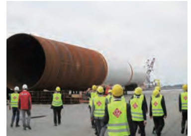
写真4 EEW Special Pipe Constructions社で製造されたモノパイル(ロストック港)
