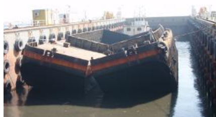
写真-2 浚渫土投入状況
