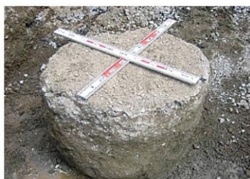
写真-2 エコガイアストーン （施工後：固結タイプ）
