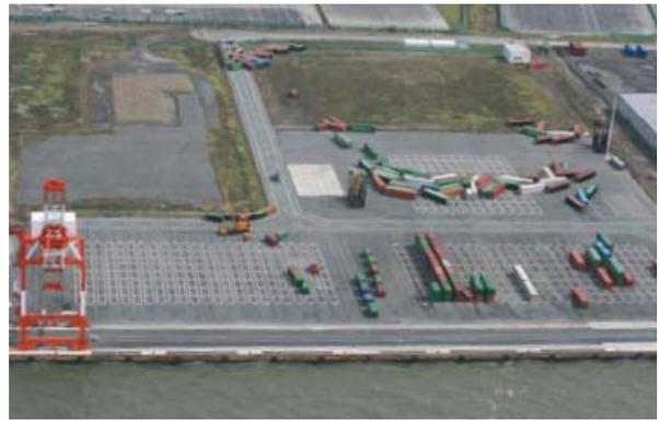
写真-5 台風18号による高潮浸水で散乱したコンテナ (中部地方整備局撮影)
