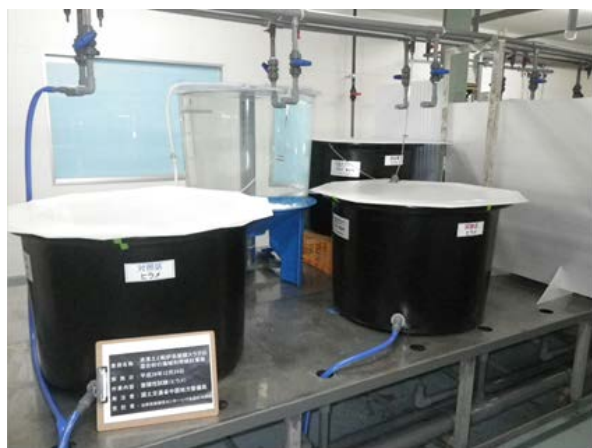
写真-2 蓄積性試験水槽
