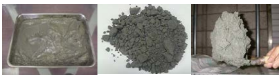
写真-1 浚渫土, 転炉系製鋼スラグ, 混合材
