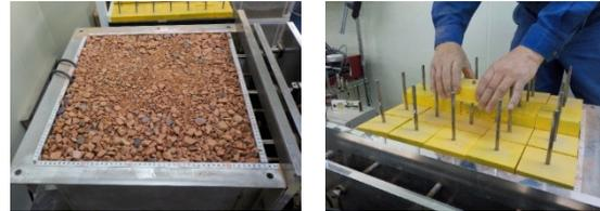
地盤材料の作成 重錘の設置状況
