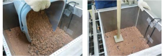
地盤材料の投入 地盤材料の締固め状況
