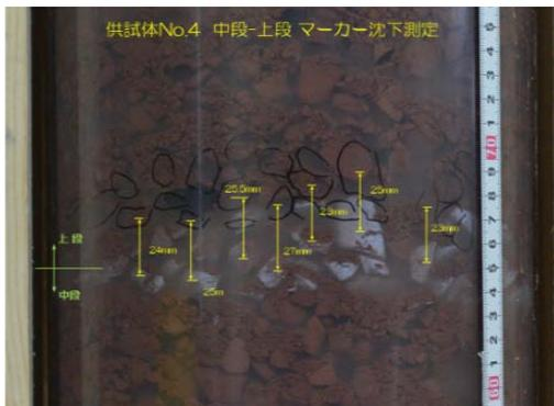
写真-3 水中投入後の振動による沈下状況
