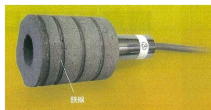
写真-4 腐食センサー (CS5)
