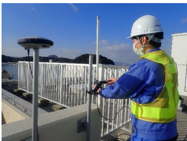
写真-1 Berth Surveyor 設置状況
