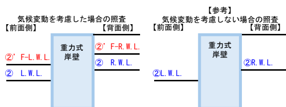
図-10 岸壁(重力式)における水位別の照査ケースのイメージ(モデル断面図)
