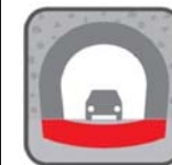
トンネル (インバート設置)
