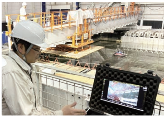
大型平面水槽での栈橋下面調査ボートの実験
