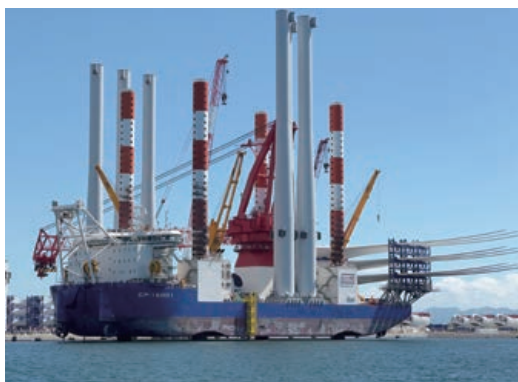
図c 北九州・響灘で風車を積み込む風車設置作業船 6)
