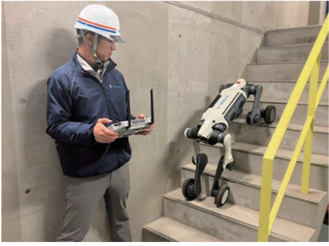
現場巡回、安全監視等のための4足歩行ロボットの技術開発
