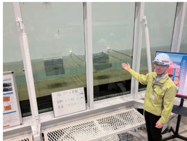
「減揺タンク」によるケーソンの動揺低減実験(大型造波水路)
