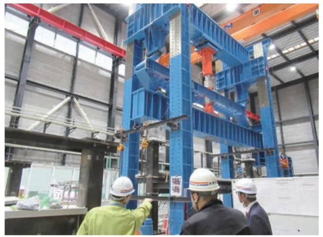
実大スケールの載荷実験ができる載荷フレーム
