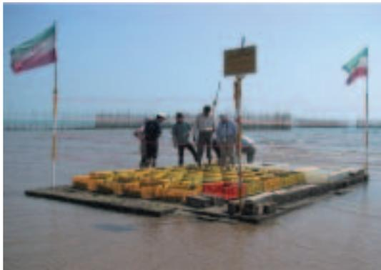
写真5 干満帯での暴露試験
