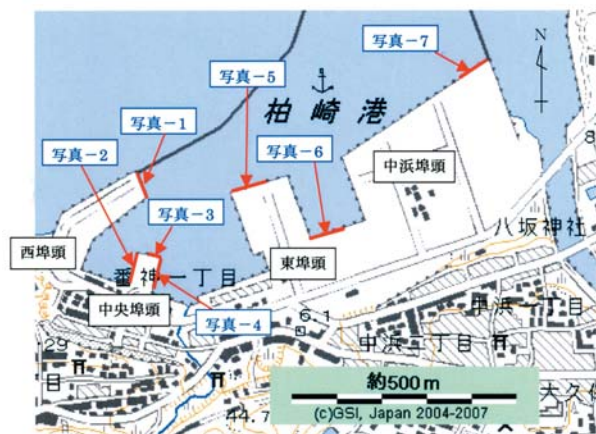
図 - 2 柏崎港岸壁被災位置図 (国土地理院HPより)
