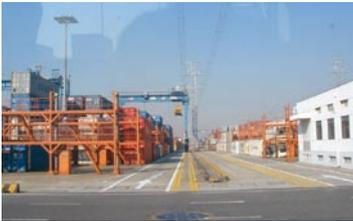
写真8 上海・外高橋港の電化および遠隔監視・操作化されたトランスファークレーン
