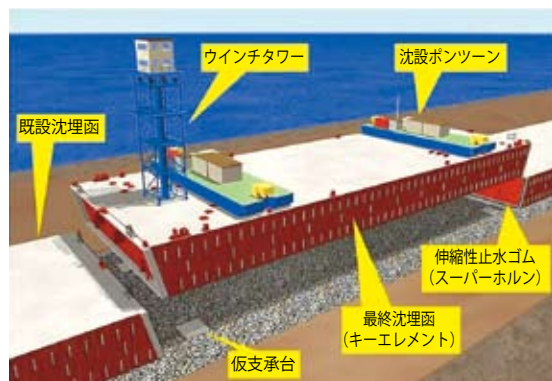
図2 キーエレメント工法概念
