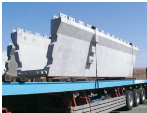
写真3 鉄筋を使用していないUFCプレキャスト桁
