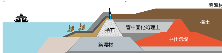
図7 羽田D滑走路築造工事における鉄鋼スラグ水和固化体(フロンティアストーン®)の適用部位
