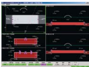
図4 最終沈埋函据付システム (沈設誘導画面)
