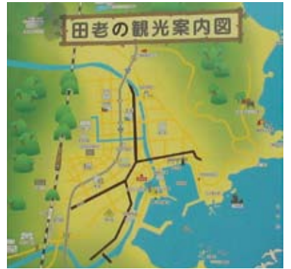
図13-b 田老町の津波防潮堤 (高さ10m、全長2433m) [1934-1988]
