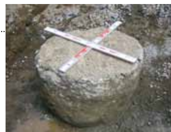
写真7 エコガイアストーン杭頭部の固結状況
