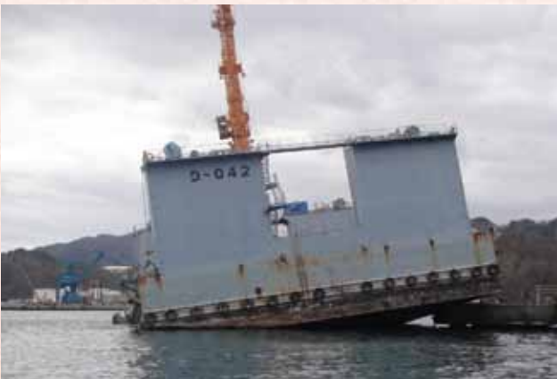
栈橋に乗り上げたフローティングドック
