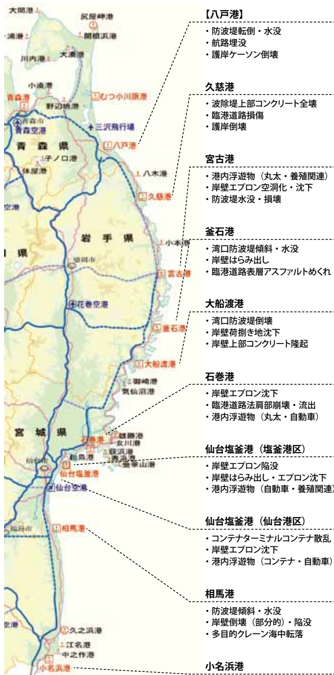
図1 東日本大震災における被災状況(港湾)
