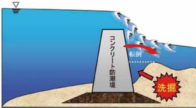
図10 越流津波による洗掘で防潮堤の崩壊
