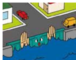
陸閘は人や車両の海岸への出入り口を閉鎖し堤防の役割を果たします。
