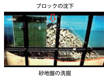
図3 消波ブロック被覆堤の砂地盤の洗掘によるブロックの沈下現象
