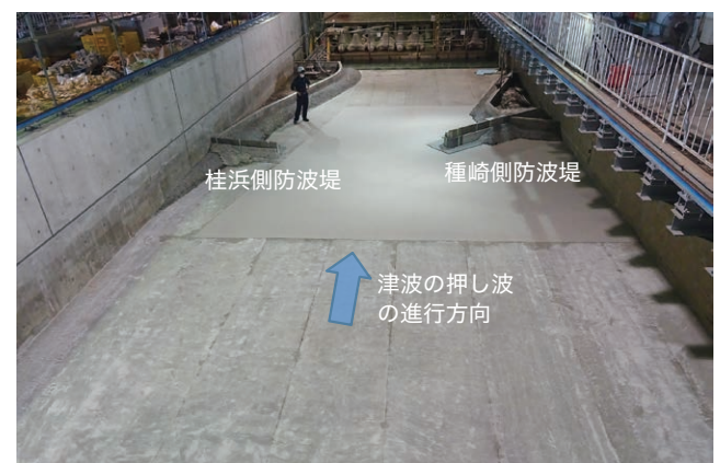
図4 高知浦戸湾口の1/40実験模型
