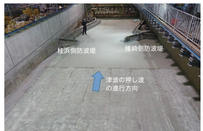
図4 高知浦戸湾口の1/40実験模型
