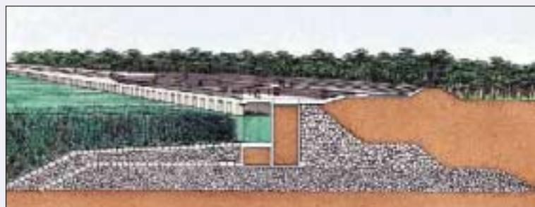
図 1 下関沖合人工島 環境共生型護岸イメージ図
