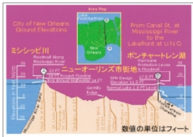
図-7 ニューオーリンズの断面 (www.mvn.usace.army.mil/pao/response/NGVD.aspx に加筆)
