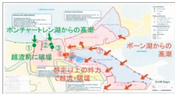
図-9 ニューオーリンズの運河と浸水の原因 (www.hq.usace.army.mil/cip/katrina/pumps/pumps.html に加筆)
