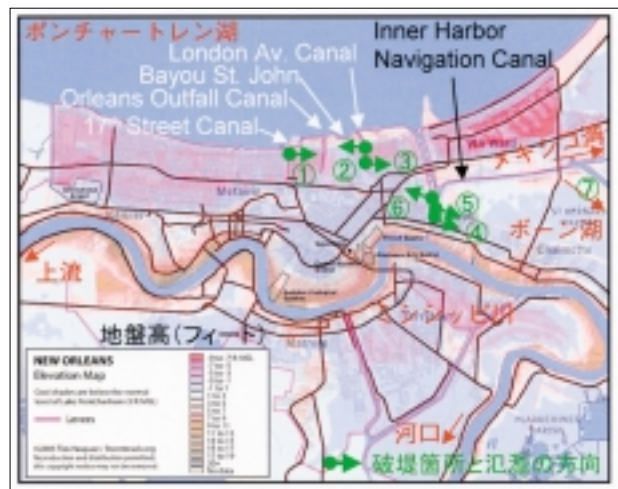
図-6 ニューオーリンズの地形と破堤箇所 (stormtrack.org に加筆)
